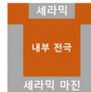
<내부 전극이 형성된 압전 시트의 평면도>
